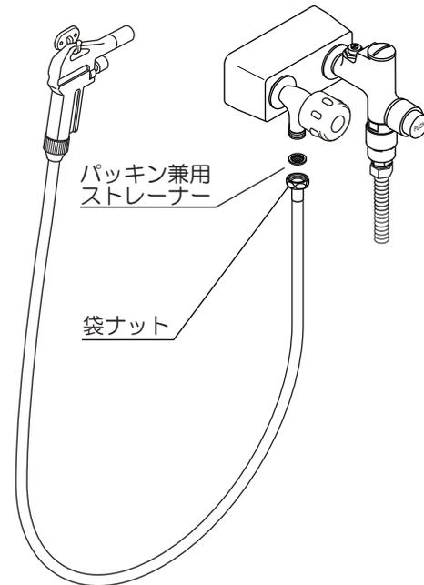
3. 洗浄ノズルのガン側を上にして、ボタンを押すと内部の残水が抜けます。
