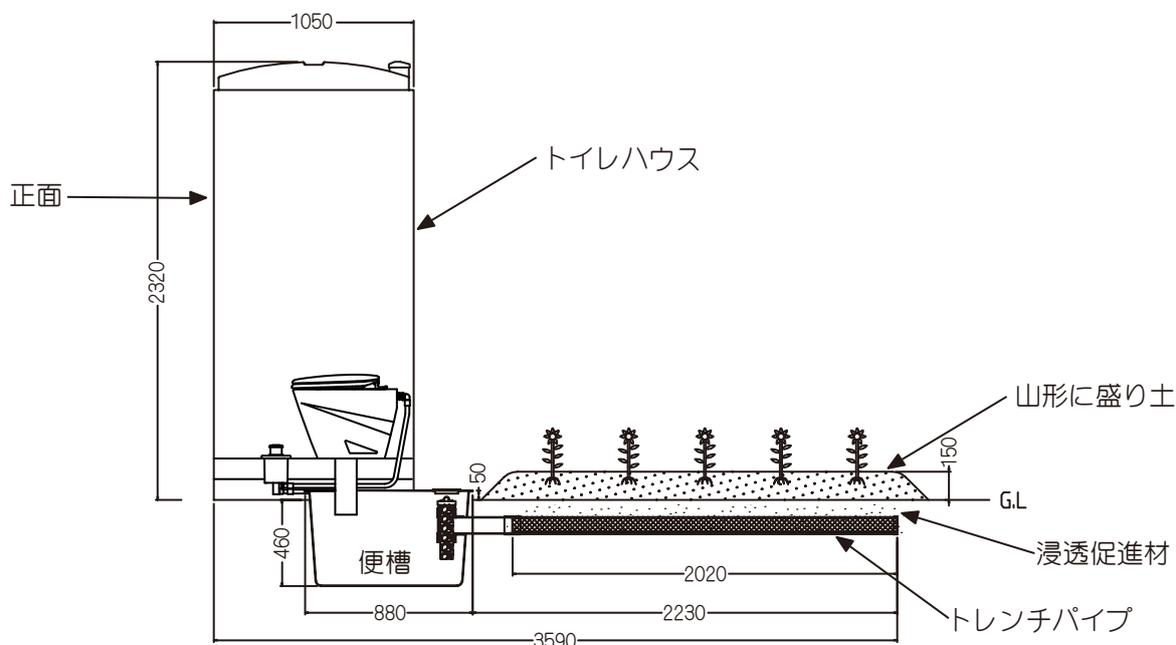
地下水位が高い場所での施工図例
