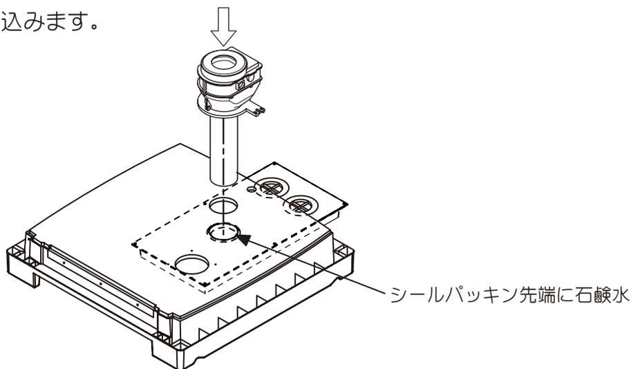
④床パネルに床置型ロートを左右2本ずつビス止めします。
