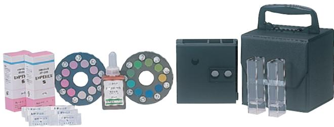
・測定用試薬 DPD 試薬 S300(50 包× 6 箱)
