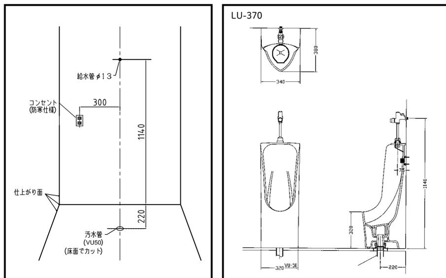
**LJ-760・777** 〈床仕上げ及び給水管位置〉下図に従って施工してください。
