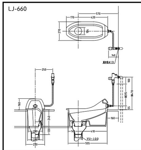
※バキュームブレイカーは、便器内吐水口(噴射ノズル)より必ず上方に取り付けることとし、その高低差は 250mm 以上に設けること。
